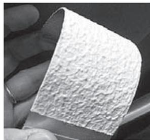
表層の硬質ナノ被膜がトップコートを不要にしました。塗膜表層にナノビーズが配列され汚れをガード。さらに表層はラジカル架橋(紫外線効果による反応)によって汚れを跳ね返す強靱な塗膜となっており、トップコートが不要なのです。
